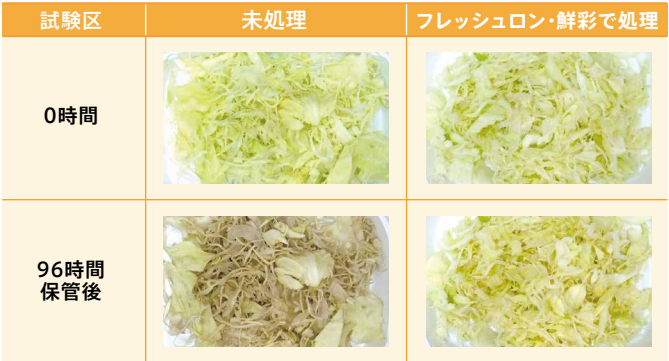
・カットしたキャベツを「フレッシュロン・鮮彩」3.0%溶液に10分間浸漬し、液切り ・10℃で96時間保管後
